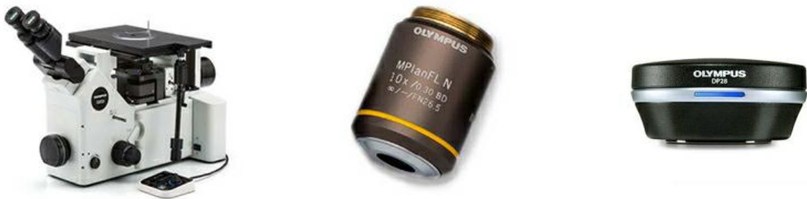
Tipica configurazione dell'apparecchiatura: microscopio metallografico rovesciato, obiettivo 10X e fotocamera digitale per microscopio a alta risoluzione.
